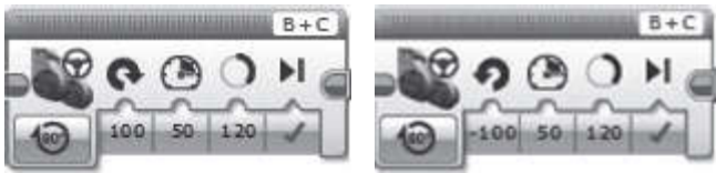
Рис. 13. Блок «Рулевое управление»: а — поворот направо, б — поворот налево
