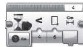
Рис. 9. Блок «Ожидание» в режиме «Ультразвуковой датчик»
