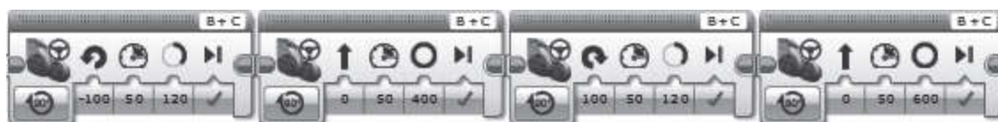
Рис. 21. Программирование объезда камня справа
